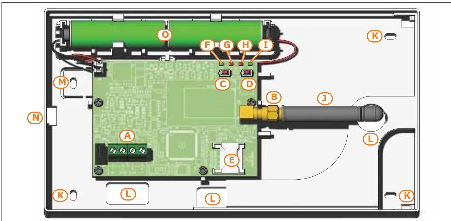
Todos los modelos de marcador están dotados de dispositivo de seguridad contra la apertura de la caja que contiene el PCB. El modelo Nexus/3GP también está dotado de seguridad contra el desprendimiento.
