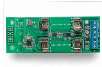
Air2-UT100 está disponible en todas las situaciones en las que es necesario enviar vía radio a la central antiintrusión Inim, una señal proveniente de una fuente genérica. Air2-UT100 tiene una entrada normalmente cerrada que envía una señal de alarma a través de radio cuando la entrada se desequilibra.
