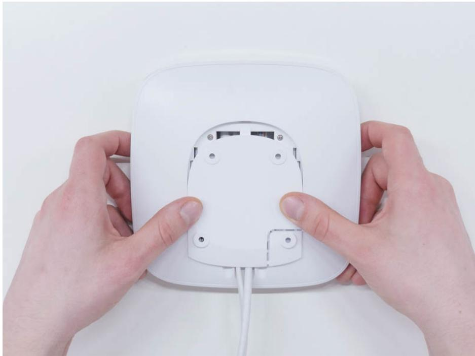
2. Apague el hub o repetidor pulsando el botón de encendido durante 2 segundos.
