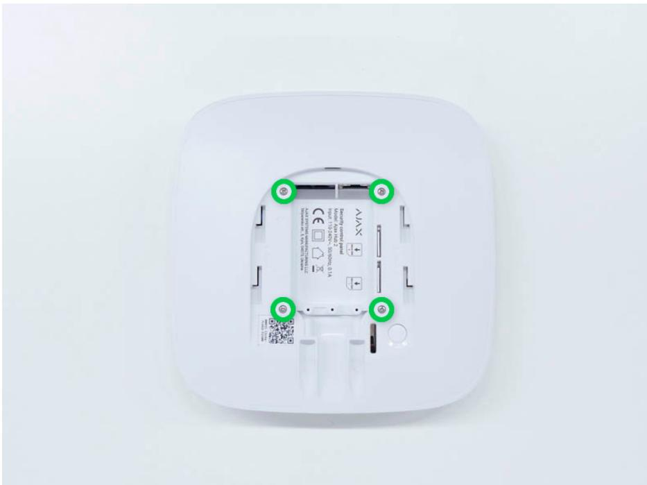
5. Retire todos los tornillos que sujetan las placas a la carcasa del dispositivo.
