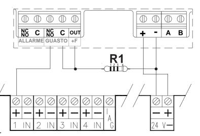
Salida de ALARMA a rele. El contacto de esta salida puede ser normalmente cerrado o normalmente abierto dependiendo de la posición del puente S7.
