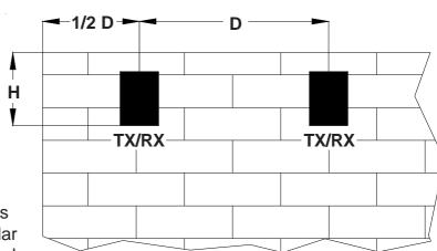
En el caso de techos inclinados, instalar la primera barrera a 1 mt aproximadamente 1 metro de la pared por el lado mas alto del techo, manteniendo la distancia H del techo. Instalar las barreras sucesivas manteniendo la **□TX/RX** 1/2 D -TX/RX
