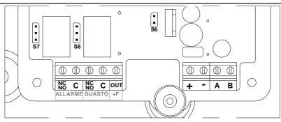
Los terminales de la tarjetas estan agrupados en dos bloques separados: el de la izquierda comprende las salidas de alarma y averia, mientras el de la derecha comprende la entrada de alimentación y la puerta serial para conexión con el panel remoto **BR100**
