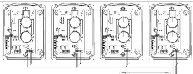
El dialogo entre el panel remoto y las barreras tiene lugar a traves de una conexion serial, como se muestra en el dibujo. Conectar los terminales A y B de cada barrera a los terminales A y B del modulo BR100.
