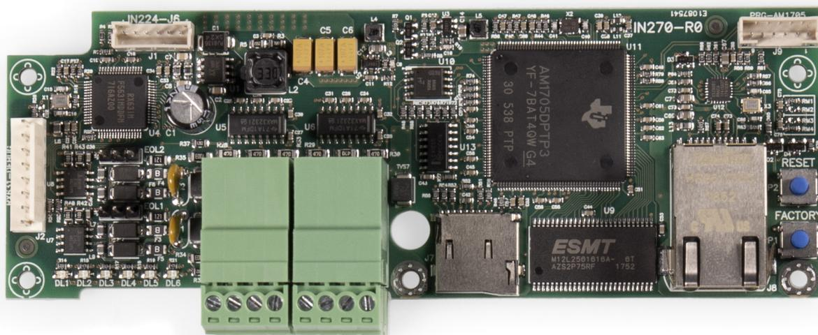
Il modulo PREVIDIA-C-COM-LAN, oltre alle funzioni descritte per il modulo PREVIDIA-C-COM (2 porte RS232 e 2 porte RS485), fornisce un socket per la connessione alla rete ethernet, per mezzo di questa seconda connessione (è necessario che siano collegate alla stessa rete sia la scheda madre che il modulo) vengono implementate le funzioni TCP-IP avanzate sotto elencate.
