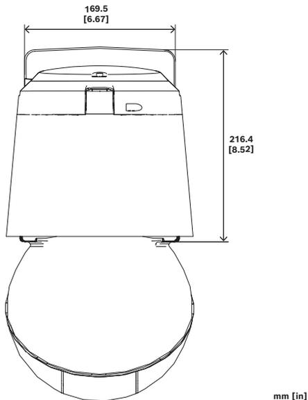
Fig. 1: Dimensiones en mm (pulg.) de la cámara en el dispositivo NDA-7100-PEN | NDA-7100-PENF (vista frontal)
