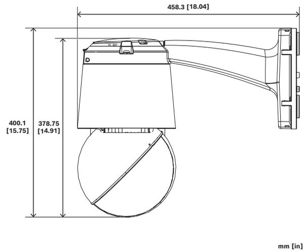
Fig. 2: Dimensiones en mm (pulg.) de la cámara instalada en el dispositivo NDA-7100-PEN | NDA-7100-PENF con NDA-PEND-WPLATE (vista lateral)
