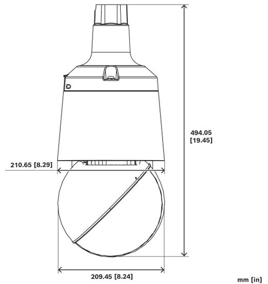
Fig. 3: Dimensiones en mm (pulg.) de la cámara instalada en el dispositivo NDA-7100-PIPE | NDA-7100-PIPEF (montaje en techo)
