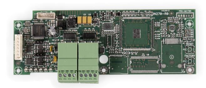
Il modulo opzionale PREVIDIA-C-COM, una volta installato all'interno del cabinet delle centrali Previdia Compact, fornisce due porte RS232 e due porte RS485 sulle quali collegare dispositivi remoti, utilizzando i protocolli di seguito (vedi tabella).
